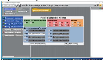
Мы только что «сказали» плате, что к его порту (выходу) A1 подключен датчик освещенности. Точно также мы «сообщаем» ей о подключении моторов, сервомоторов, и других датчиков.
