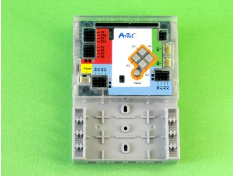
Рисунок 4. Центральный блок ArTec
