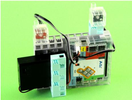
Рисунок 10. Модель автоматического управления освещением
